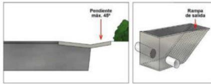
9. **Se recomienda que en las cunetas longitudinales revestidas de hormigón sus paredes exteriores tengan una pendiente inferior a 45°** para paliar el efecto-barrera, que de otra forma ejercen las cunetas sobre pequeños animales. Del mismo modo, en el caso de construcción de **pozos cuneteros** para recogida de agua, **se deberán**
