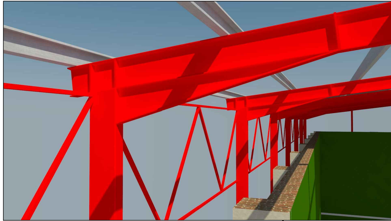
DETALLE 1 APOYO PÓRTICO PILAR
