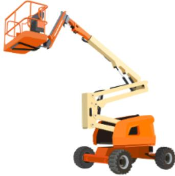
Según la clasificación de la norma UNE EN 280:2014, la plataforma a alquilar se deberá corresponder con Móvil de brazo (3B): Plataformas de brazo articulado autopropulsadas. 3B plus (3B+), teniendo en cuenta que:
