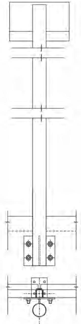
Primero se procederá a la construcción de la zapata corrida del uro, y al muro propiamente dicho, con sus transiciones a la solera en cota superior. Luego se rellenará la plataforma excavada y se compactará. Se añade la zaorra sobre el geotextil y se vuelve a compactar. A continuación se realiza la solera; se colocan las placas de anclaje y se colocan los tubos y la malla.
