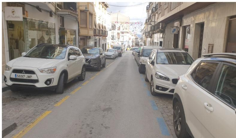
Todos los Acerados existentes se van a demoler cambiando las secciones de calle existentes. Se ha optado por anular la zona de aparcamientos del margen derecho y dotar de aparcamiento para carga y descarga en el margen izquierdo, donde la sección de la calle nos lo permita, aumentando significativamente el ancho de aceras existente actualmente, permitiendo espacios de paso adecuados. Se colocarán dos pasos de peatones, uno de ellos elevado, para ralentizar la velocidad del tráfico rodado.
