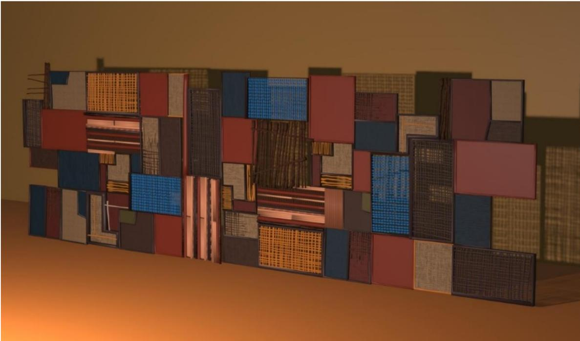
Se trata de dos piezas fabricadas mediante la unión de diferentes bastidores. Ambas tendrán el mismo aspecto visual pero con diferente parcheado permitiendo que el encuentro entre ellas será tal que encajen perfectamente una con la otra. Se trata de una estructura móvil formada por un bastidor metálico o de madera, a decidir por la empresa adjudicataria del bloque, que llevará en su frontal el recubrimiento descrito a continuación.
