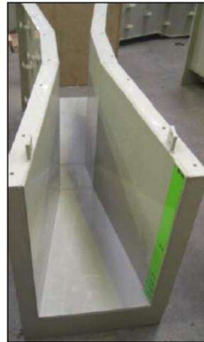
Es preciso tener un flujo laminar (caudal horizontal, agua estancada sin remolinos) y no debe haber obstrucciones ni en la boca de entrada ni en la salida del canal.
