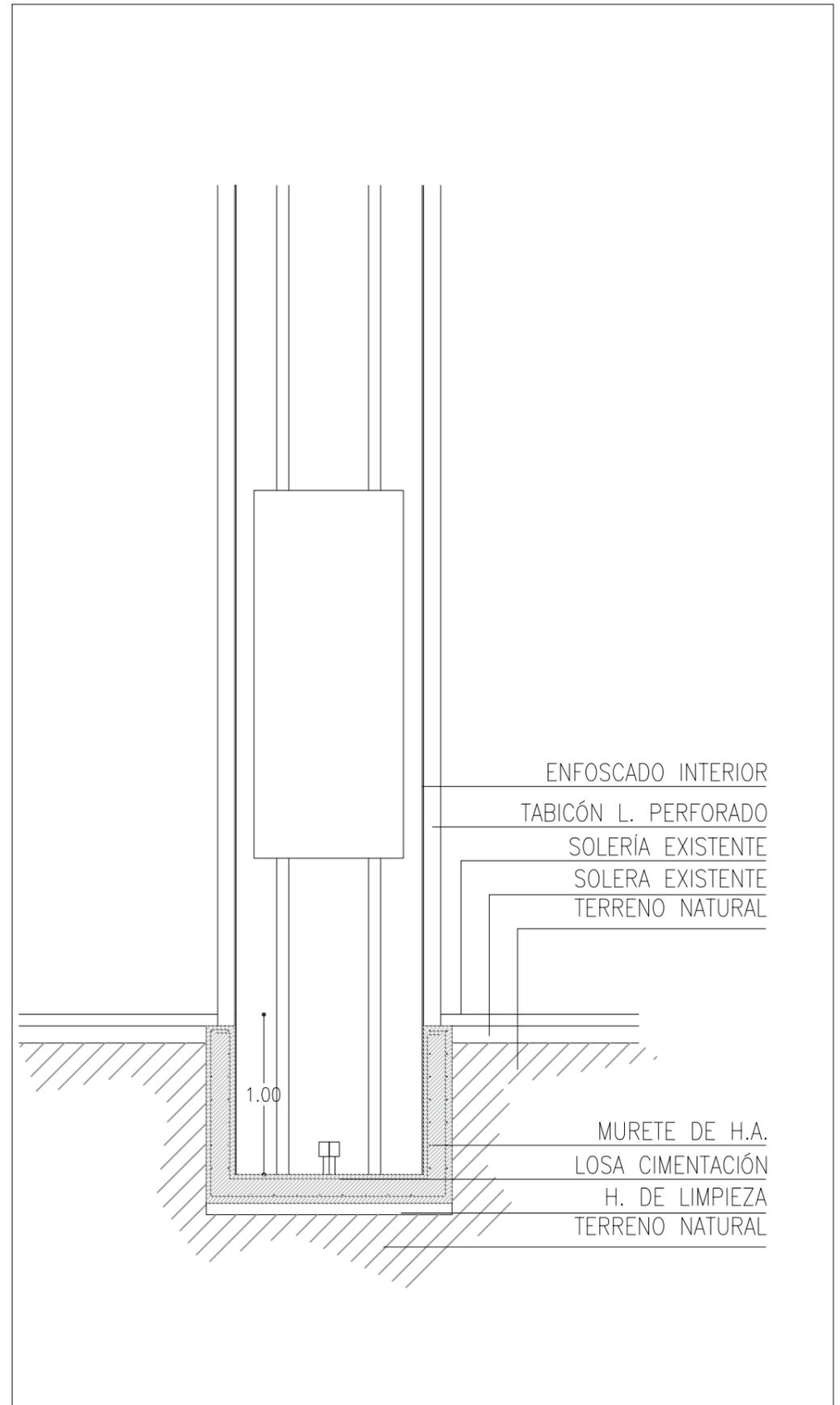
ASCENSOR. ESTADO ACTUAL Y REFORMADO. PLANTAS Y PLANTA DE ESTRUCTURA. E 1:100
