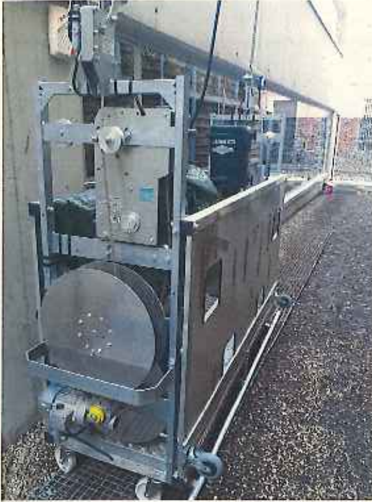
Foto 5- Detalle plataforma de elevación para mantenimiento de jardín vertical
