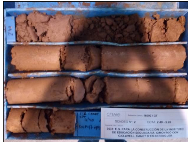
Figura 2. Testigo sondeo 2 (2.40 a 5.20 m)
