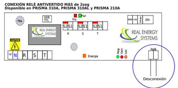
Opciones de actuación del relé de seguridad del PRISMA para evitar el vertido de energía a la red > 2 seg.
