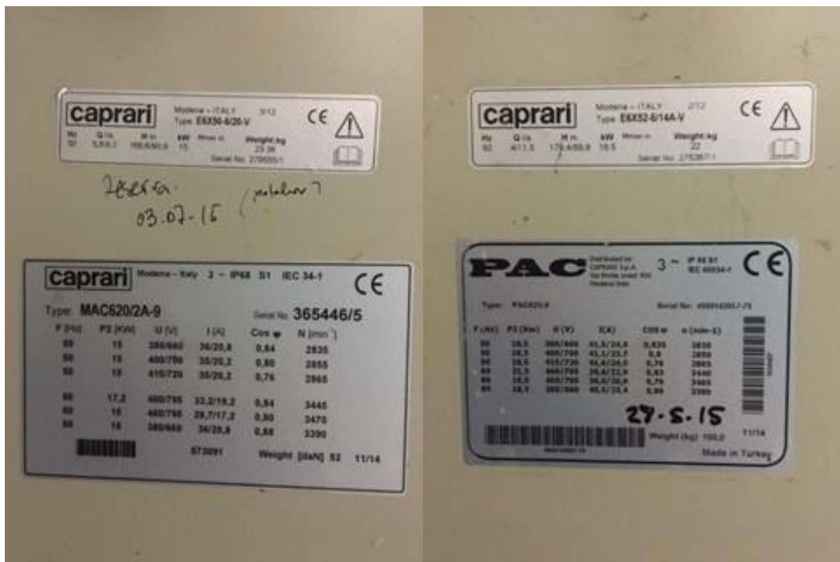
Placa características de bombas
