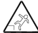
CAIDAS A DISTINTOS NIVEL
