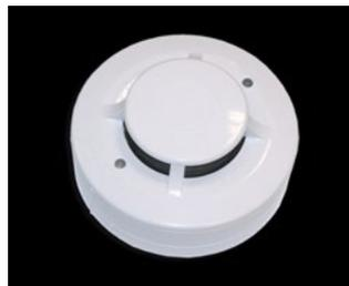
Detector AE/C5-OP: óptico de humos. Basado en una cámara óptica con emisor y receptor de luz que toman medidas de la luz que dispersa las partículas de humo y generan alarmas cuando se alcanzan los parámetros programados.
