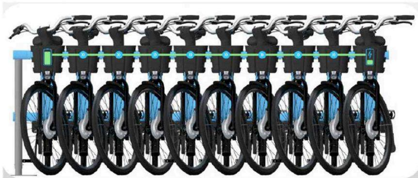
Imagen 1. Esquema del anclaje en serie y recarga de las bicicletas.
