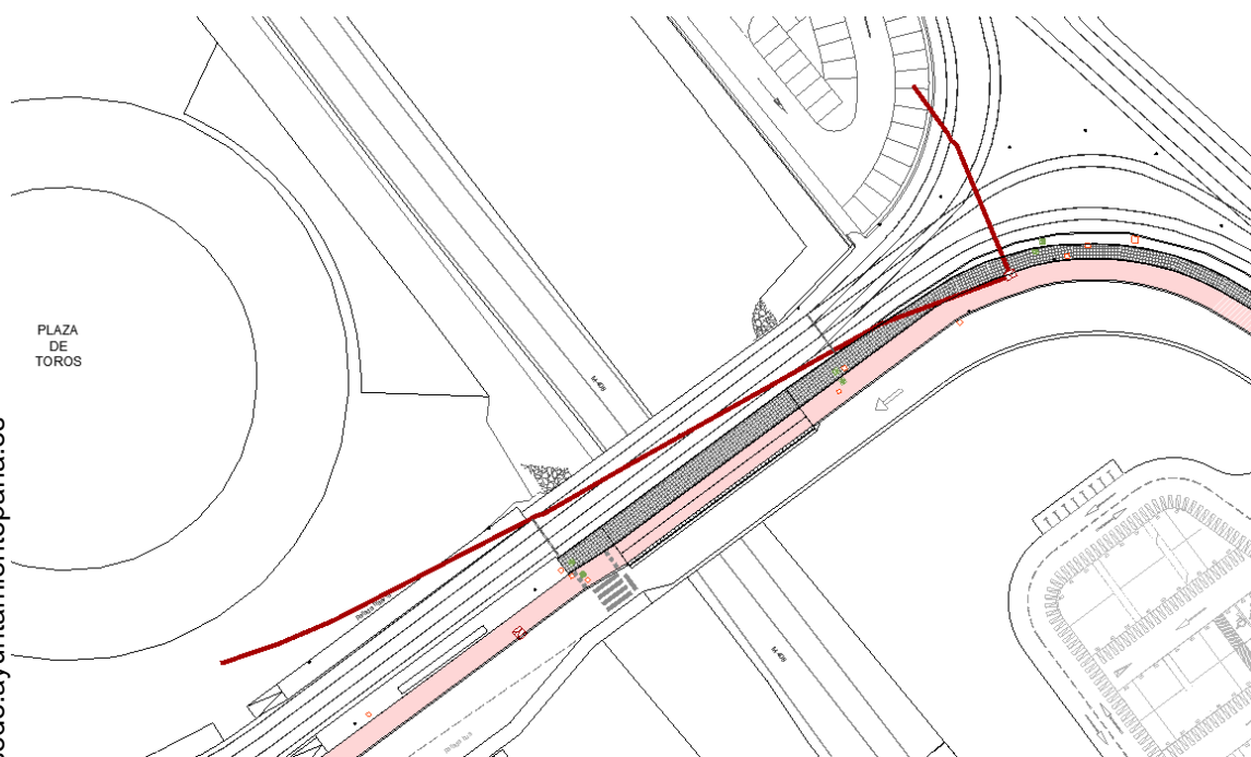
Figura 6. Redes de telecomunicaciones situadas en viales de borde de la parcela de aparcamiento sur.
