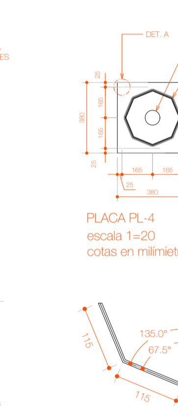
RM-06 acero S275-JR e=6mm plegado semi-octógono
