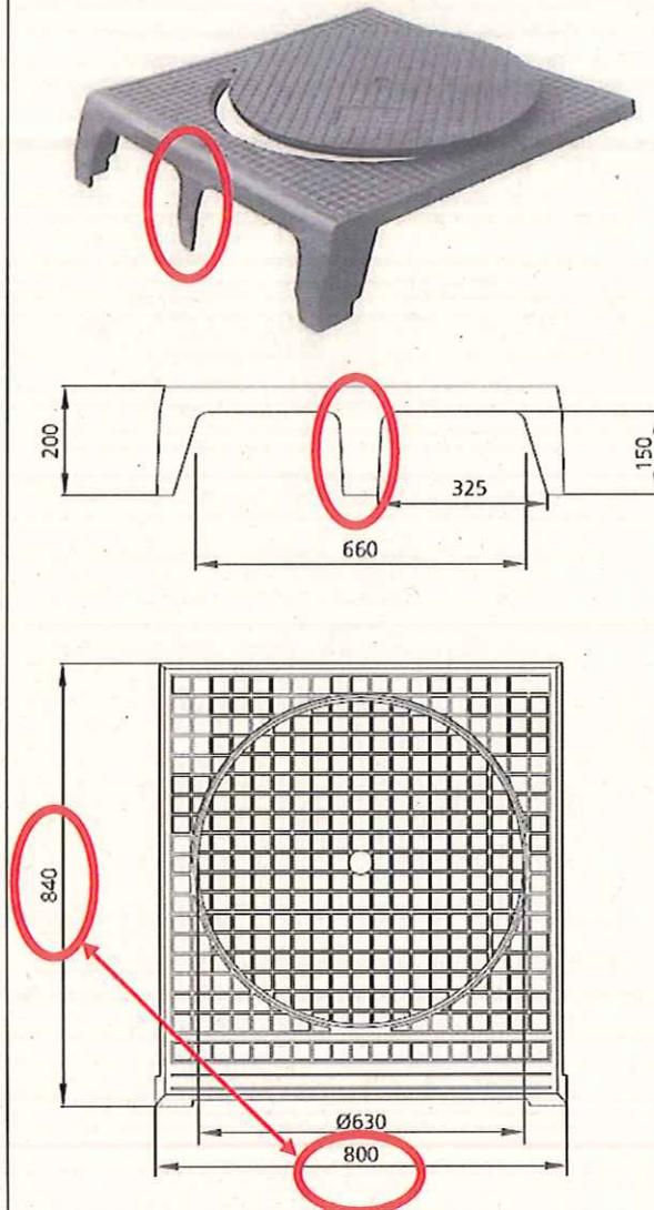
El material ofertado tiene una pata adicional en el tragadero, que no se establece en el pliego técnico (además de no ser de cerco cuadrado, sino rectangular (840x800))
