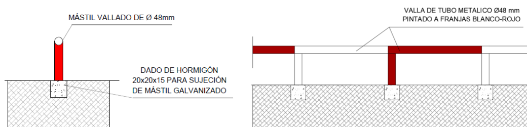
Figura 42. Detalle del vallado del helipuerto
