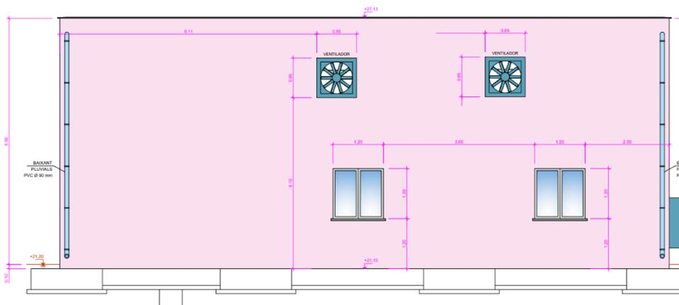
Se instalará también un termostato en la sala. Se incluirá la instalación eléctrica para programar el funcionamiento de los ventiladores (marcha/paro) en función de una consigna dada según la temperatura del termostato.
