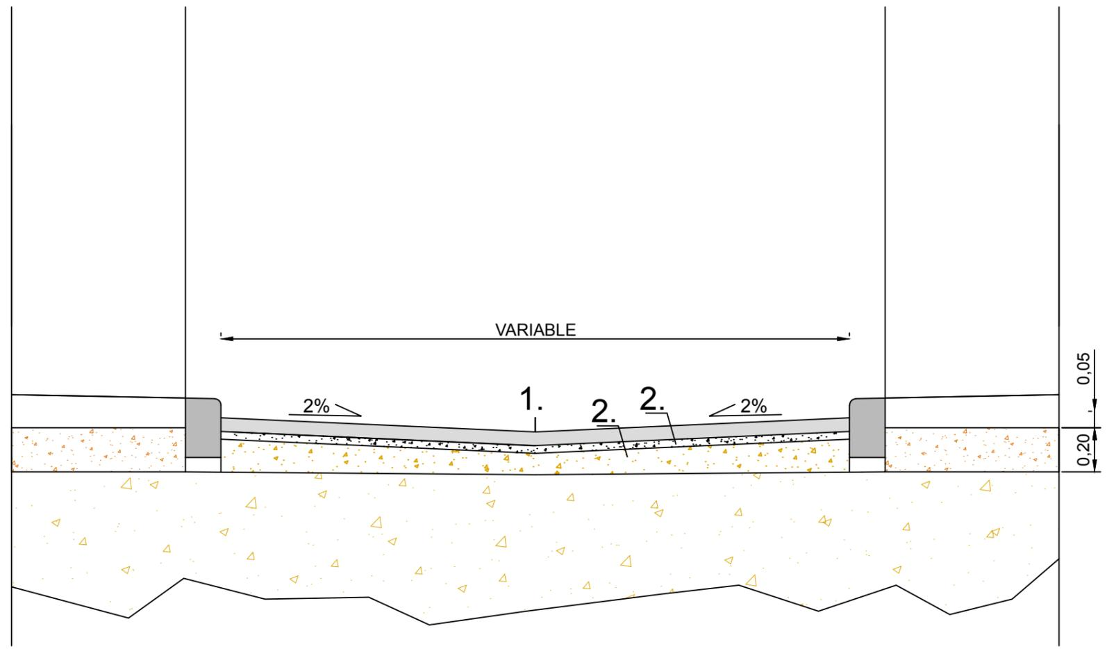
1. Aglomerado asfáltico en caliente de 5 cm de espesor AC16 SURF 50/70 (antigua D-12) extendido y consolidado en obra
