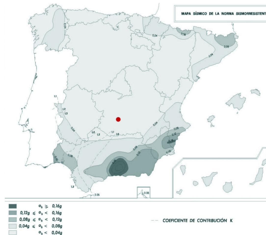
En el Anejo 1 de la Norma Sismorresistente se detalla por municipios los valores de la aceleración sísmica básica iguales o superiores a 0,04 g, junto con los del coeficiente de contribución K.
