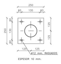
NOTA: EL ACERO EN PILARES Y PLACAS DE ANCLAJE ES DE CALIDAD A-42 B
