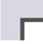
Esquina saliente *<br>Transmitancia del elemento U: 0.2388 W/(m <sup>2</sup> ·K)<br>Salto térmico: 25.00 °C  | 1.09         | 0.07        |
