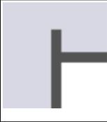
Cubierta plana *<br>Transmitancia del elemento U: 0.2920 W/(m <sup>2</sup> ·K)<br>Salto térmico: 25.00 °C | 9.55         | 0.30             |
