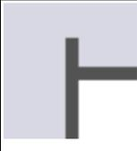
Cubierta plana *<br>Transmitancia del elemento U: 0.3541 W/(m <sup>2</sup> ·K)<br>Salto térmico: 25.00 °C | 3.69         | 0.19             |
