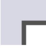
Esquina saliente *<br>Transmitancia del elemento U: 0.2535 W/(m <sup>2</sup> ·K)<br>Salto térmico: 25.00 °C | 10.04        | 0.06        |
