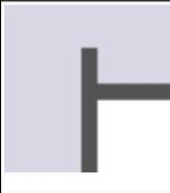
Cubierta plana *<br>Transmitancia del elemento U: 0.2608 W/(m <sup>2</sup> ·K)<br>Salto térmico: 25.00 °C | 0.38         | 0.14             |
