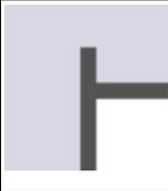
Cubierta plana *<br>Transmitancia del elemento U: 0.2066 W/(m <sup>2</sup> ·K)<br>Salto térmico: 25.00 °C   | 5.96         | 0.11             |
