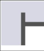
Cubierta plana *<br>Transmitancia del elemento U: 0.2910 W/(m <sup>2</sup> ·K)<br>Salto térmico: 25.00 °C | 4.59         | 0.32             |
