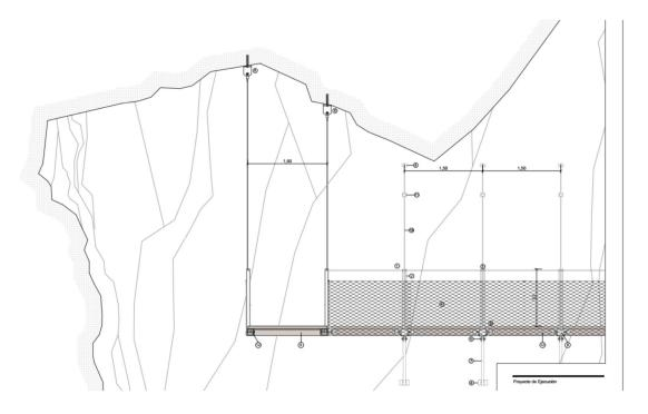
Por lo tanto, la tipología constructiva del Proyecto de ejecución Paso de la Garganta del Tajo consiste en una estructura portante de acero anclada a las paredes de la garganta, con tablas de madera a modo de pavimento y unos elementos de protección mediante mallas de acero inoxidable tensadas con cables de acero y barandilla del mismo
