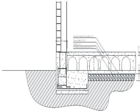
Detalle de muro y elevación de planta.
