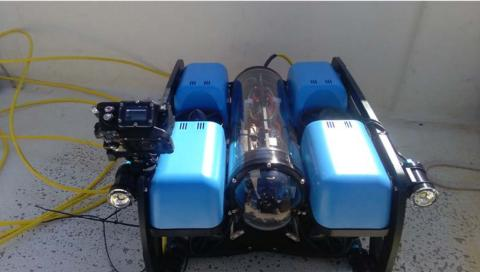
El "ROV" cuenta con cámara HD integrada, sistema de iluminación y una cámara HD anexa complemantaria.
