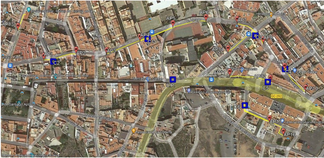
Figura 3. Propuesta ubicación de puntos de acceso WiFi (AP)
