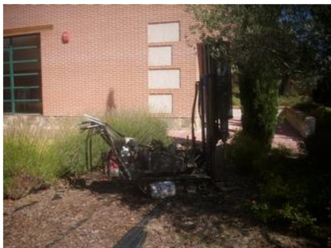
Ensayo de penetración dinámica P2
