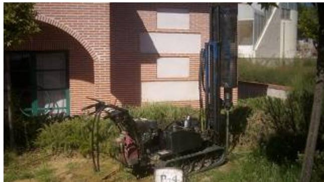
La representación en un gráfico, del número de golpes de cada tanda en función de la profundidad, proporciona una caracterización cualitativa de las variaciones resistentes del terreno con la profundidad, que puede cuantificarse mediante determinadas correlaciones cuya fiabilidad depende de la naturaleza del terreno.
