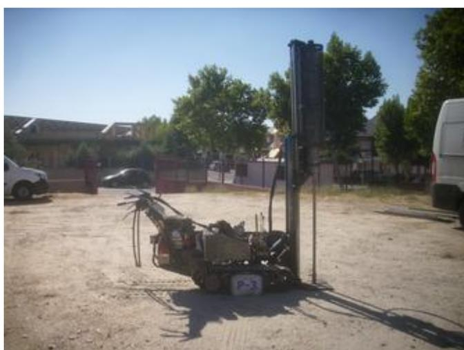
Ensayo de penetración dinámica P3
