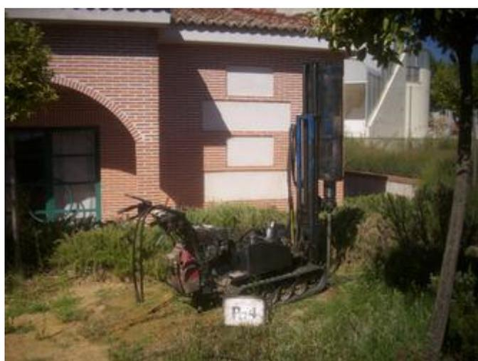
Ensayo de penetración dinámica P4
