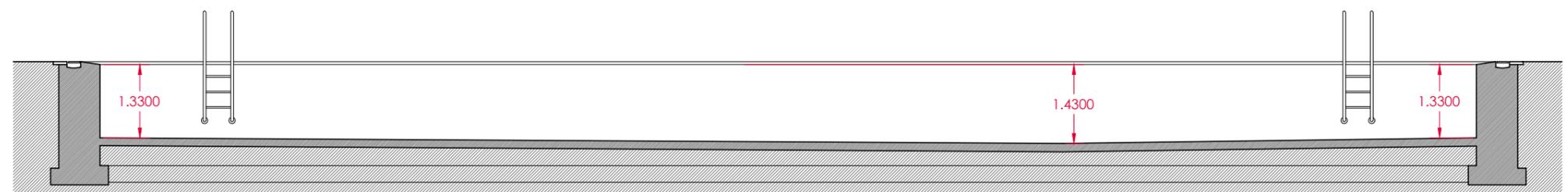
**Retirada de embaldosado actual e instalación de lámina de PVC en la piscina municipal de Peguera**
