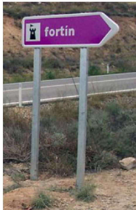
Panel de señal informativa de localización y orientación, de acero galvanizado, de 195x95cm, normas MOPT, reflectante, sobre poste galvanizado de 2,5m de longitud
