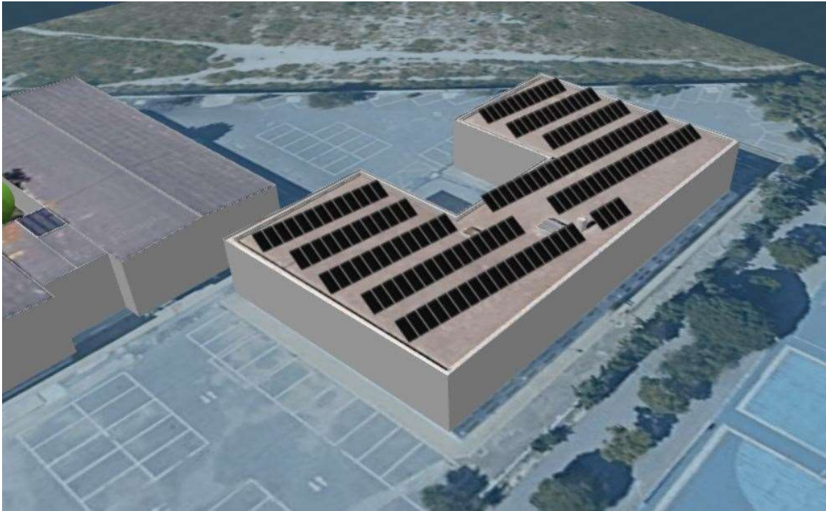
Ilustración 43 Distribución de los módulos en la cubierta.
