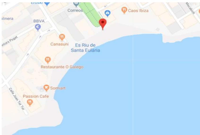
En 2019 se realizó la instalación de una red Mesh en la zona de la Playa de Santa Eulària mediante un punto de acceso MAESTRO/ROOT central, el cual está conectado a internet. Este punto hace de interconexión con los otros APs cercanos.
