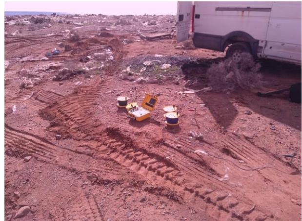
El principio de funcionamiento se da de la siguiente manera: al introducir una intensidad  $I$  en el terreno a través de los electrodos de corriente C1 y C2, aparecerá en los electrodos de tensión P1 y P2 una diferencia de potencial  $V$  que mediremos con el aparato.
