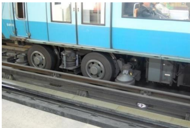
Imagen 8. Ejemplo de material rodante con guiado de rodadura neumática
