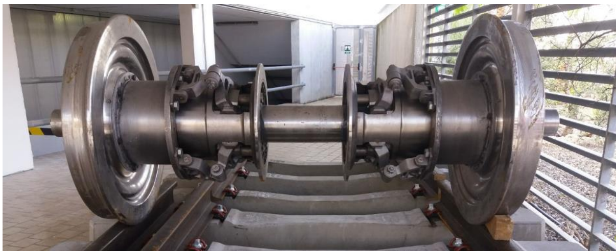
Imagen 1. Aspecto general del EAVM certificado actualmente por ADIF.
