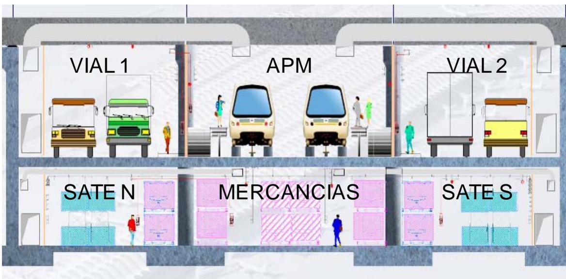
Ilustración 3. Distribución de tubos en P-2 y P-3 del túnel TSA
