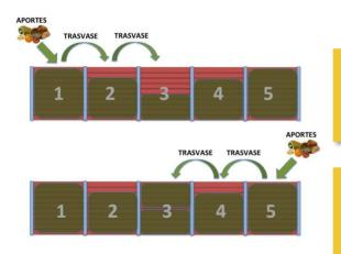
Nueva clausura del módulo 5 cuando está completo, trasvase del material del módulo 2 al 3 y del 1 al 2. El módulo 1 vuelve a ser módulo de aportación.
