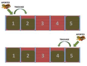
Clausura del módulo 5 cuando está completo, trasvase del material que estaba en el módulo 1 al módulo 2 y el módulo 1 vuelve a ser el módulo de aportación.
