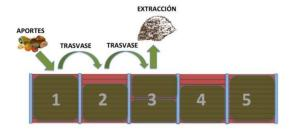
Extracción del compost del módulo 3. Clausura del módulo 5 cuando está completo, trasvase del material del módulo 2 al 3 y del 1 al 2. El módulo 1 vuelve a ser módulo de aportación.
