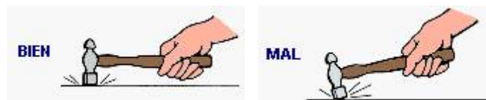
Fig. 7: Forma de golpear sobre una superficie
