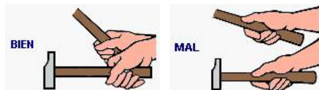
Fig. 6: Forma de sujeción del mango
