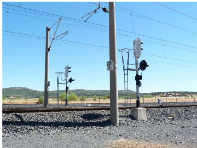
Ilustración 11 Señales altas de salida.
