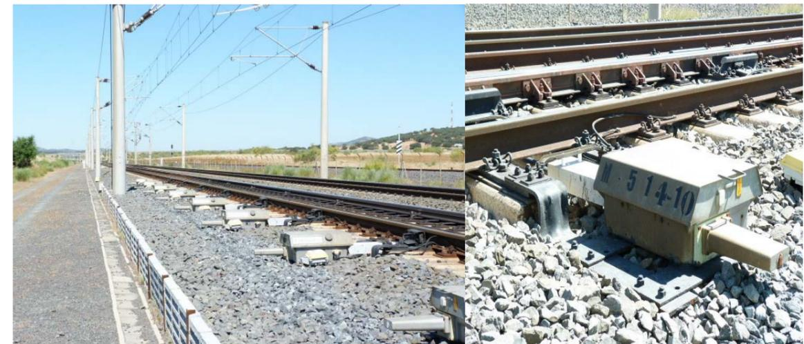
Ilustración 15 Accionamientos de aguja tipo L700H en el desvío nº A514, situado en la vía 1 de Brazatortas.
