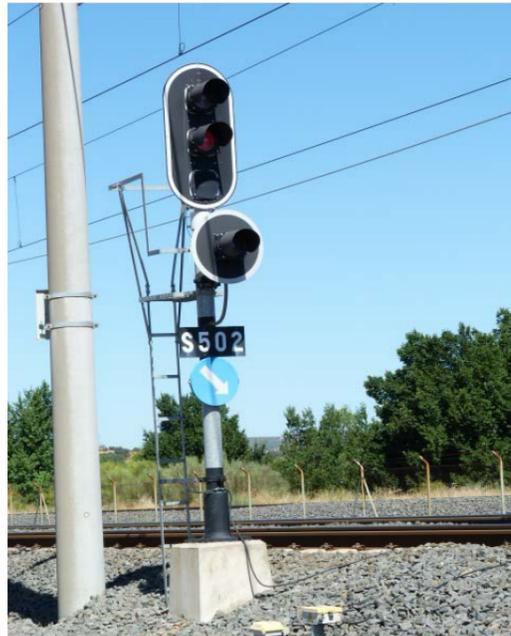
Ilustración 5 Señal alta de 3 focos con piloto y escaleta.
