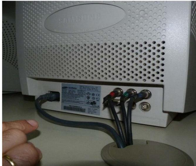
Ilustración 9 Detalle de los tres conectores RGB de monitor videográfico antiguo del PLO.
