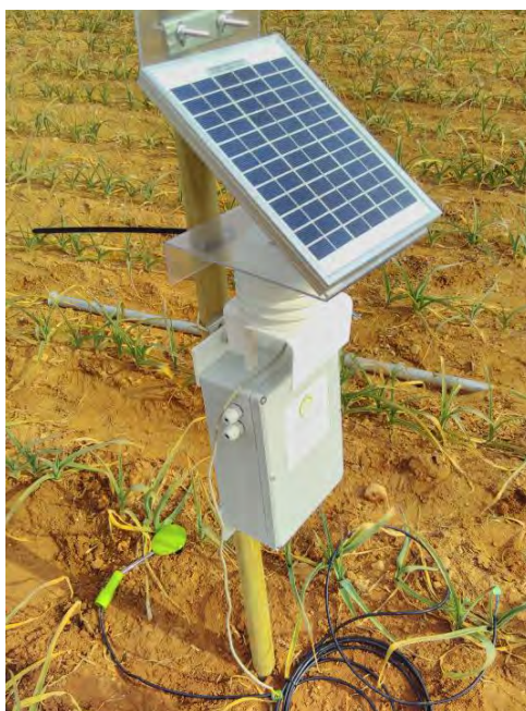
Imagen nº1: Muestra de un sistema de control de la humedad en el suelo.
