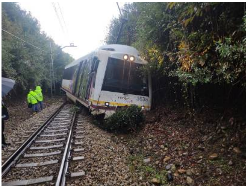
Imagen de la unidad descarrilada tras arrollar el desprendimiento. Se observa el coche de cabeza que fue el más afectado. Se observa la densa vegetación en los taludes.
