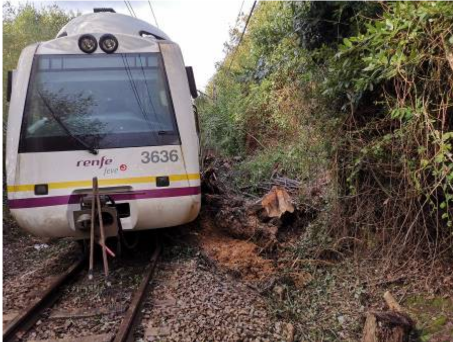
Coche de cola de la unidad accidentada. Este coche no llegó a descarrilar. Se observa a la derecha restos del desprendimiento y de la vegetación que también cayó.
