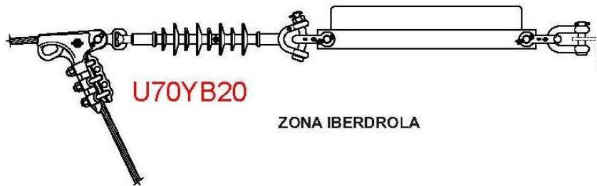
Figura 1.c. Aisladores de Poliméricos de 24 kV, Tipo U 70 YB de Iberdrola
