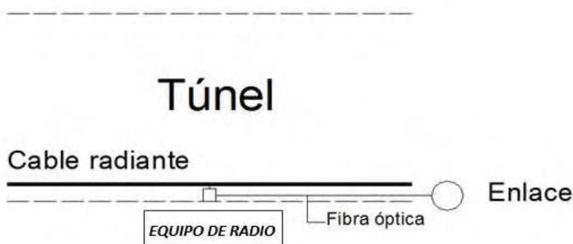
Figura 10. Esquema conexionado Túnel de Los Roquillos
