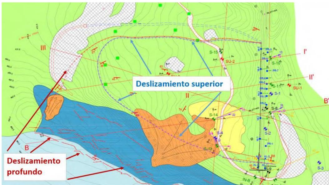
Figura 5.- Planta geológica geotécnica con indicación de los deslizamientos
