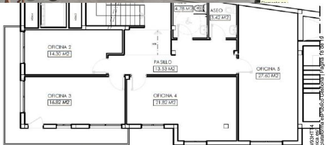
PLANTA ALTA REFORMADA (SUPERFICIES)
