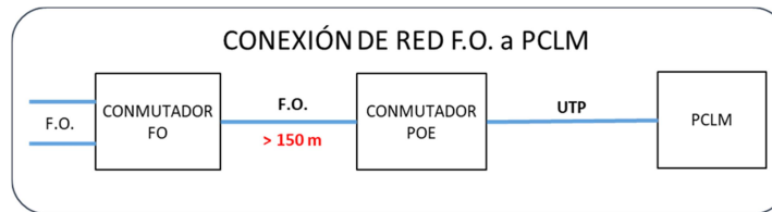
ILUSTRACIÓN 6 CONEXIÓN A LA RED DE FO DE PUNTOS DE CONTROL A MÁS DE 150 M DEL NODO
